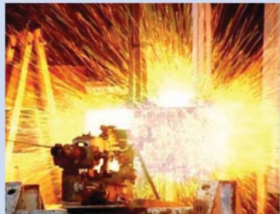
Испитивање пробојности панцирног зрна
