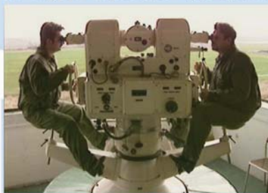
Теодолитски систем за снимање трајекторије лета вођених ракета
