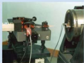
Еталон помераја код вибрација – ласерски интерферометар
