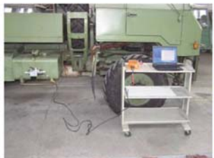
Datron – Correvit уређај за мерење динамичких карактеристика возила
