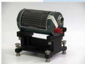
Термисторска сонда – еталон микроталасне снаге
