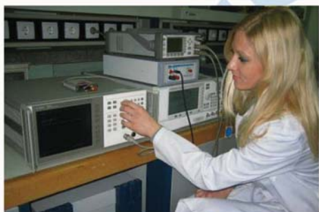
Еталонирање сензора снаге до 26,5 GHz
