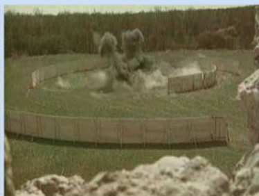
Испитивање парчадног дејства пројектила у арили
